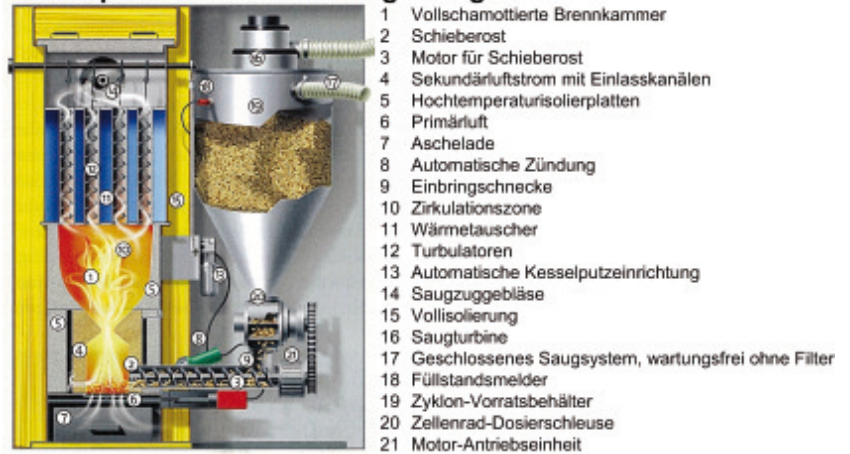
Bild 18. Prinzip der Biomassenutzung mittels Holzpellets zur Beheizung und Warmwasserversorgung [34]
