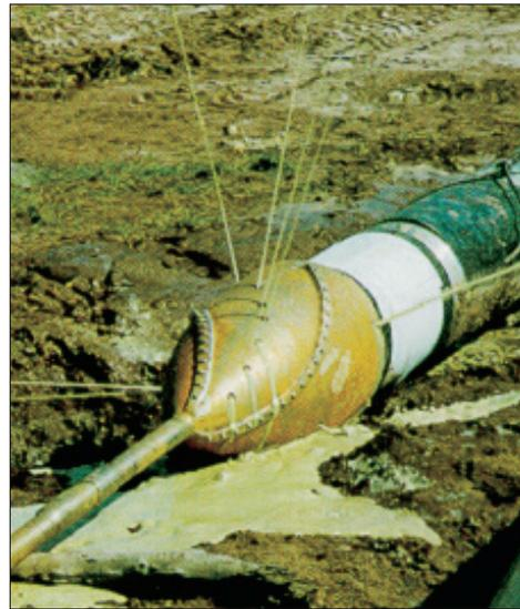
Bild 2. Aufweitungsbohrkopf
