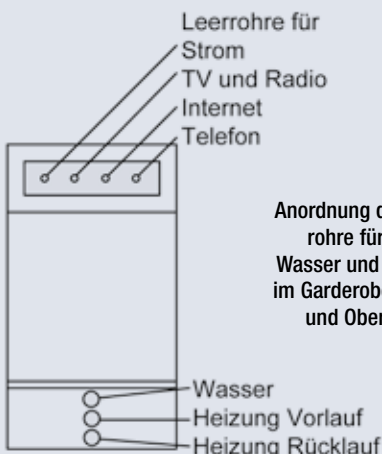
Querschnitt der Decke mit Anordnung der Leerrohre
